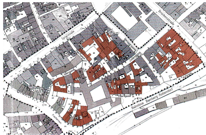
Abb. 23: Schweinfurt. Das Sanierungsgebiet Südliche Altstadt mit Einzeichnung der Entkernungs- und Abbruchmaßnahmen.
